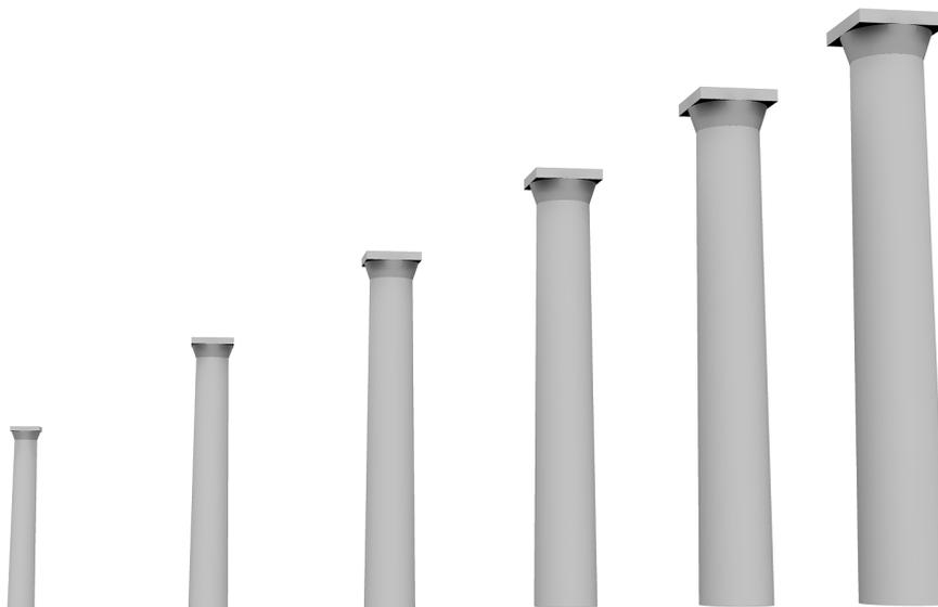
Figura 2.39: Variações de colunas dóricas segundo as proporções de Vitruvius.
