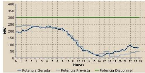
Fig 4 – Produção de electricidade e previsão no conjunto de parques eólicos com telemetria. Dia de maior queda de potencia em 8 horas em 2005
