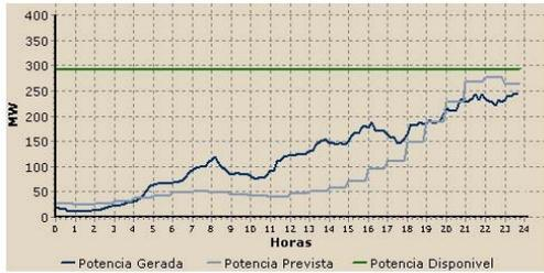
Fig 3 – Produção de electricidade e previsão no conjunto de parques eólicos com telemetria. Dia de maior subida de potencia em 8 horas em 2005
