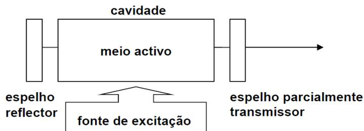
Fig. 4.8 Representação esquemática de um laser.
